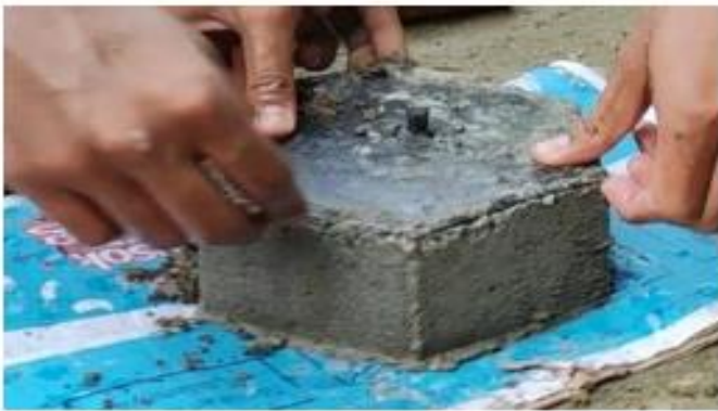
Gambar 2. Persiapan alat dan bahan, Simulasi pembuatan paving blok , dan produk paving blok dari limbah slag nikel
